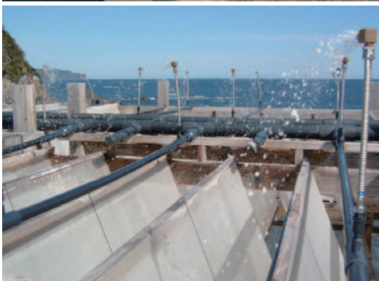
写真右上／塩の素となる鹹水をつくる採鹹タワー。鳥や虫が混入しないよう、ネットで覆っている。
